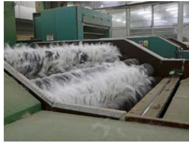
In der Fabrik wird das Vlies von Erde und Gras befreit, gewaschen und getrocknet.
